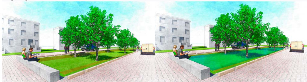
47 Baumrigolen in Versickerungsmulden ohne (links) und mit Wasser (rechts)
