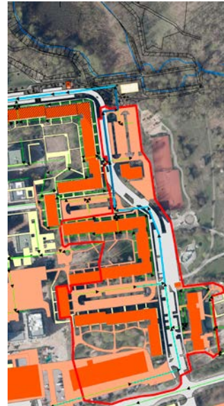
52 Neues Einzugsgebiet des Beerenpfuhls (rechts) durch Anschluss der Regenwasserkanalisation (links) ©Ingenieurgesellschaft Prof. Dr. Sieker mbH
