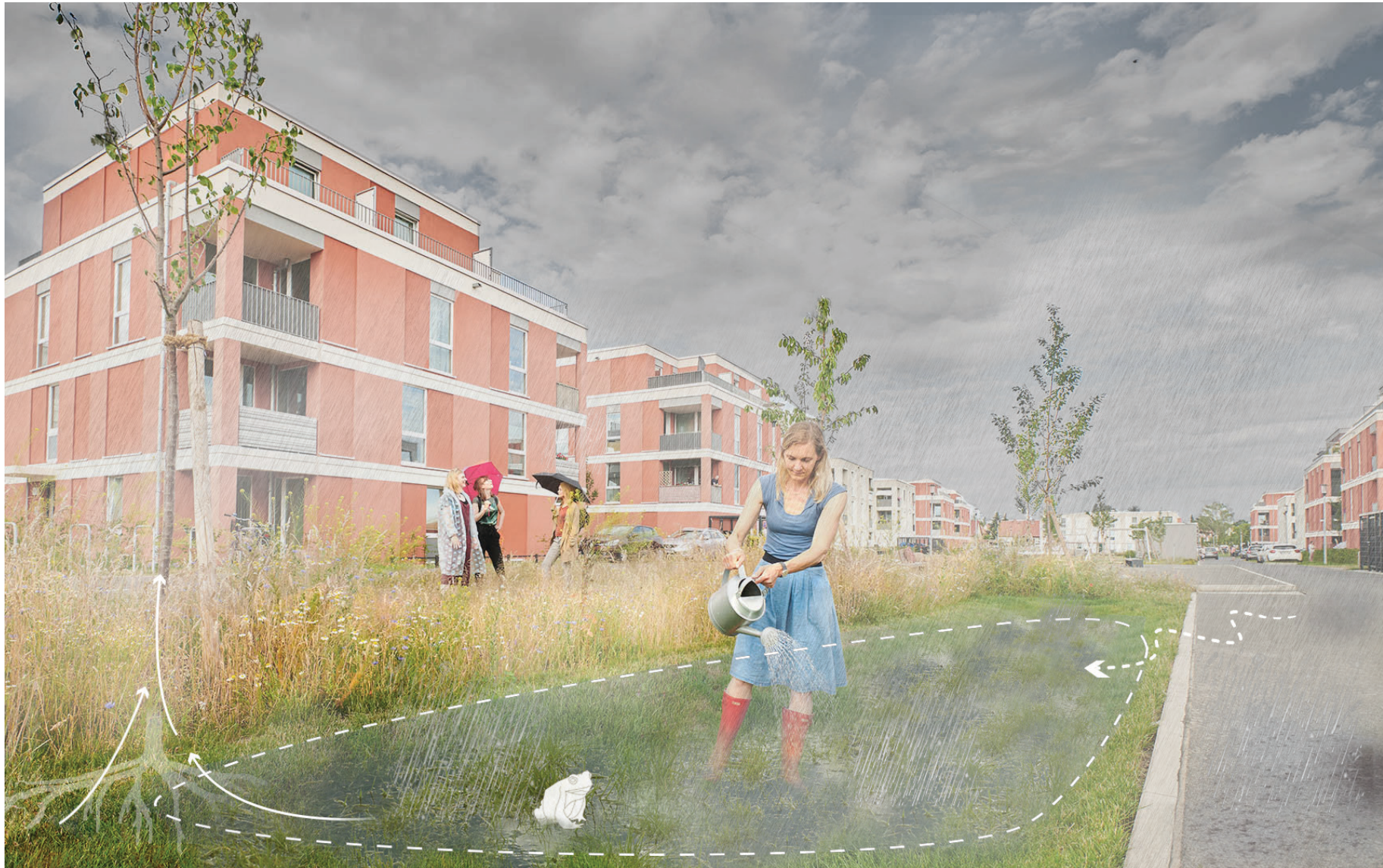
Abb. 80 - Rasenmulde mit Baum als Maßnahme der dezentrale Regenwasserbewirtschaftung im Wohnquartier Ortolfstraße, Berlin [12]
