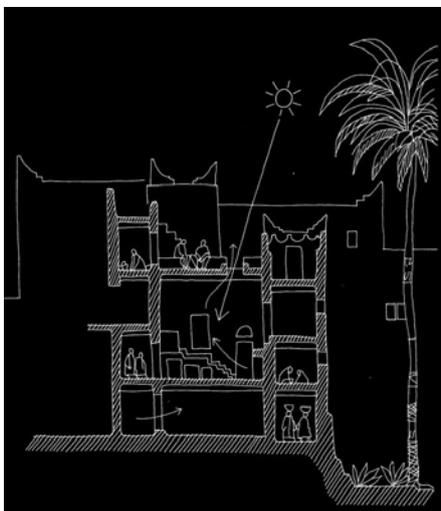
Abb. A38 - Diagramm Durchlüftung
